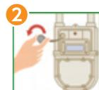
復帰ボタンのキャップを手で左に回し、キャップを外してください。
